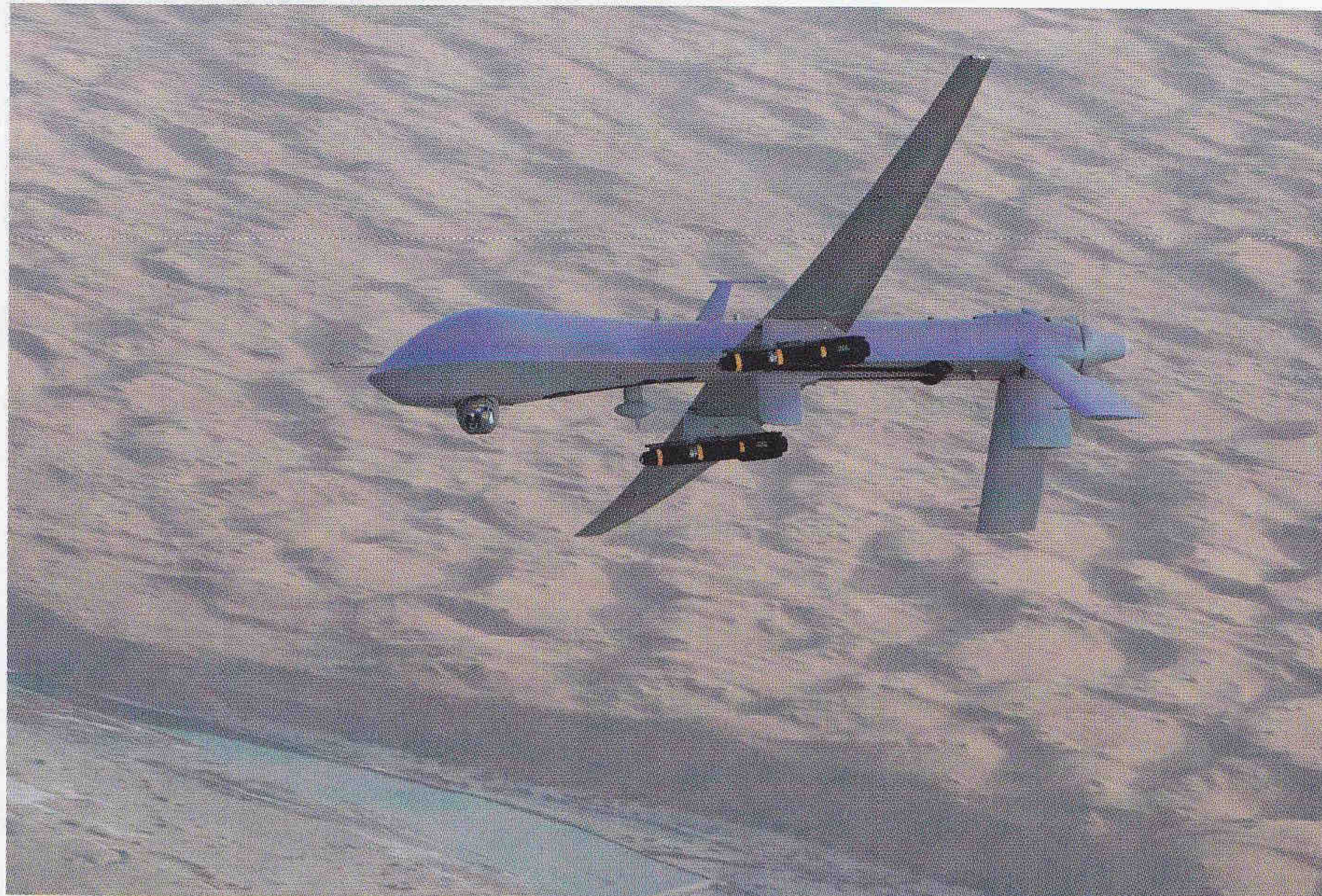
В качестве основного средства поражения на БЛА типов «Предейтор» и «Рипер» сегодня применяются управляемые ракеты класса «воздух – поверхность» AGM-114 «Хеллфайр». На фото на «Предейторе» видны две такие ракеты
